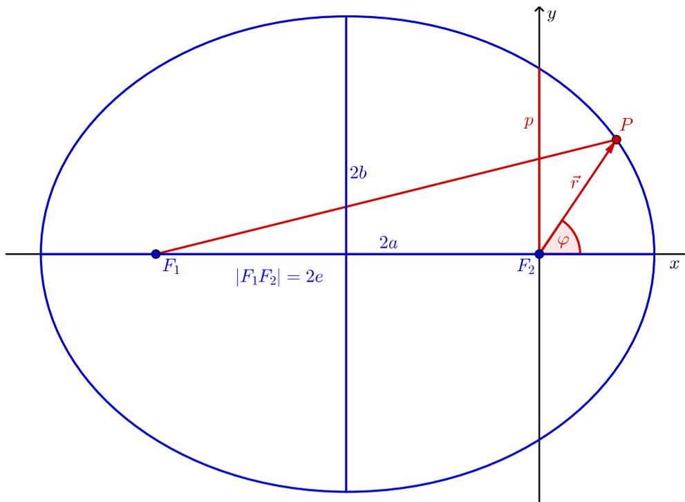
Man liest aus der Skizze ab, daß hierbei  $a$  die große Halbachse der Ellipse ist. Weiter folgt für die definierende Gleichung in den eingezeichneten Polarkoordinaten
