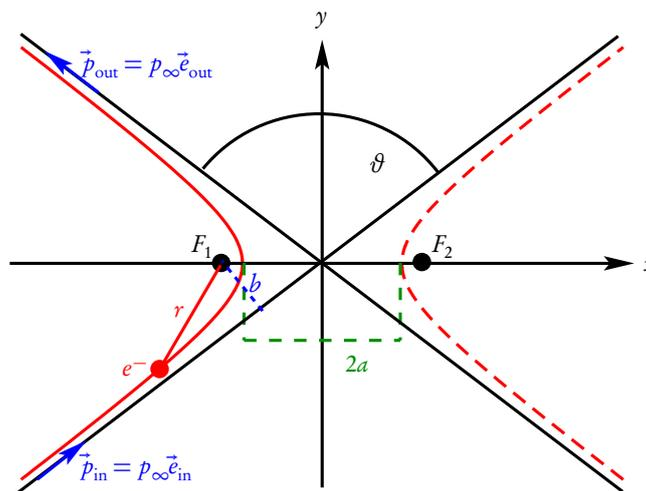
Abbildung 1: Hyperbel bei der Elektron-Kernstreuung. Der Kern sitzt fest im Brennpunkt  $F_1$  der Hyperbel. Deren Gleichung lautet im eingezeichneten Koordinatensystem  $x^2/a^2 - y^2/\tilde{b}^2 = 1$ , wobei die „imaginäre Halbachse“ durch  $\tilde{b} = \sqrt{e^2 - a^2} = \sqrt{a^2(\epsilon^2 - 1)} = a\sqrt{\epsilon^2 - 1}$  gegeben ist.
