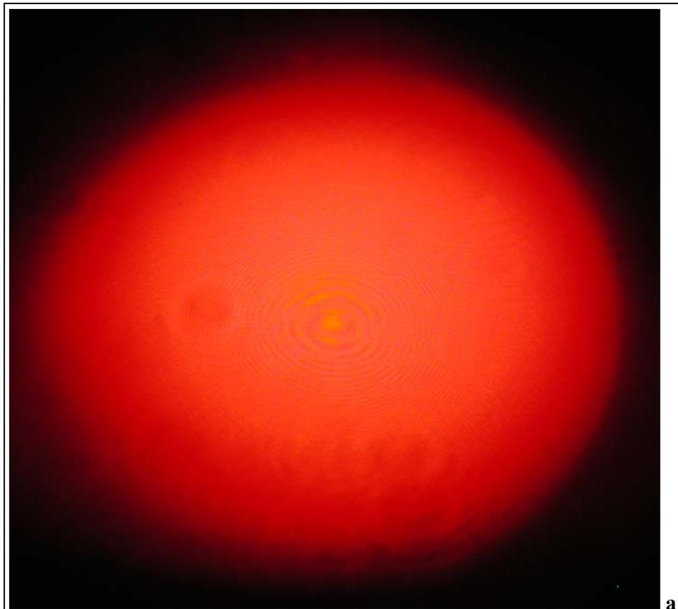
**Abb. 23a und b:** Die Fotos zeigen die Interferenzringe, wie sie sich nach Überlagerung der beiden Interferenzstrahlen auf dem Beobachtungsschirm einstellen. Die Flecken in den Ringen kommen durch Verunreinigungen der verwendeten Linsen zustande.
