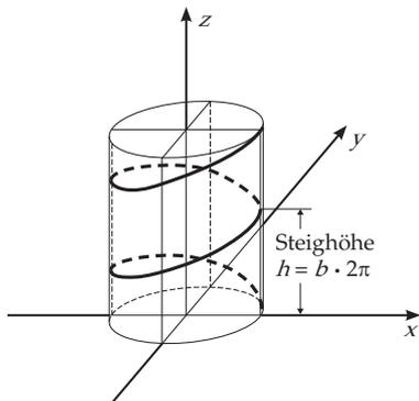
Ein kleiner Körper mit der Masse  $m$  gleitet unter dem Einfluß seines Eigengewichtes reibungsfrei auf der Schraubenlinie
